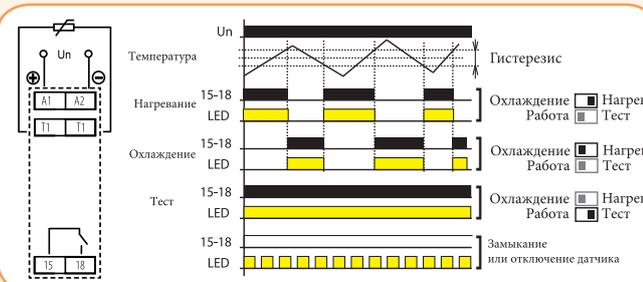
Реле представляет собой простой, но практичный термостат со съемным датчиком для контроля температуры. Устройство можно разместить в распределителе, а датчик может измерять температуру помещения, предмета или жидкости. Питание гальванически не изолировано от датчика, исполнение последнего соответствует требованиям двойной изоляции. При повреждении или замыкании датчика,
