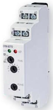
**Применение** - служит для задержки включения/выключения питания (например при отключении напряжения - обеспечение работы резервного источника питания) - аварийное освещение, аварийная вентиляция, обеспечение управления автоматическими дверями (например у лифтов), а также эскалаторами. Таймер реле начинает отсчет времени после пропадания напряжения питания.
